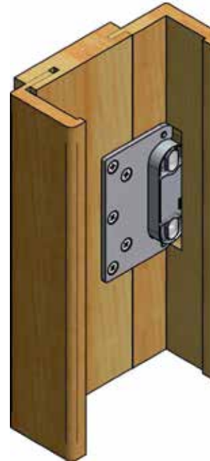
ocelový element k uchycení 3D pantu
